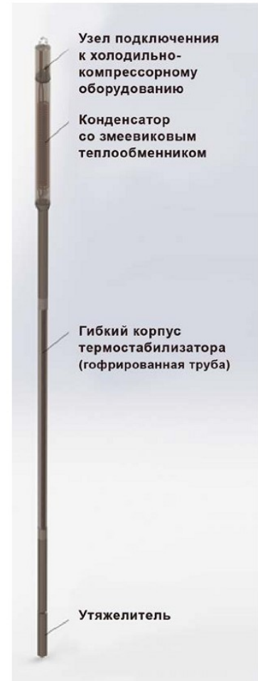
Рис. 3. Модель термостабилизатора грунта с гибким корпусом, подключаемого к системе хладоснабжения
