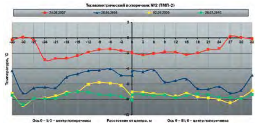
рисунок 6б. Показания температур термоперечника
